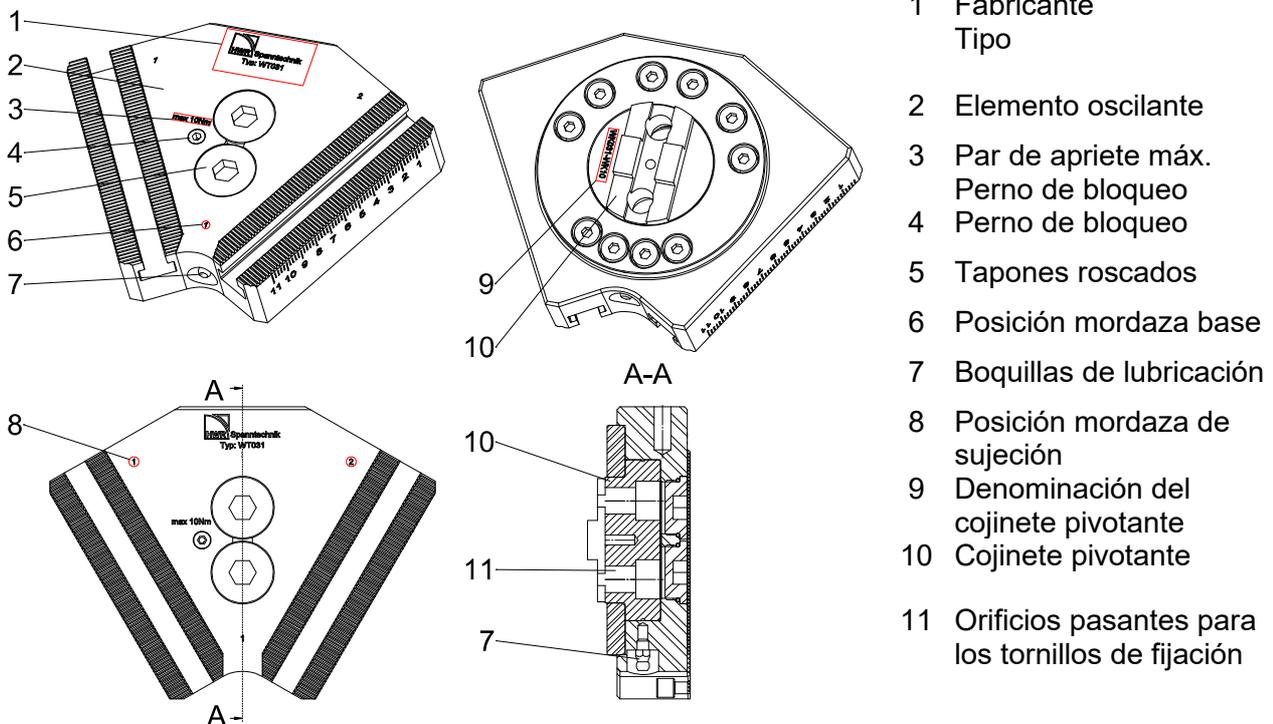
Fig. 2-1: Estructura de los puentes oscilantes INOZet®
