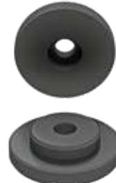
Zur konzentrischen Ausrichtung Ihrer **SOLIDPoint®** Platten bieten wir Ihnen den passenden Zentrierstutzen an. Alle unsere Platten haben an der Unterseite eine 20H7 oder 50H7 Passbohrung und können so auf die gängigsten Bohrungsdurchmesser (30, 32 und 50 mm) Ihres Maschinentisches adaptiert werden.
