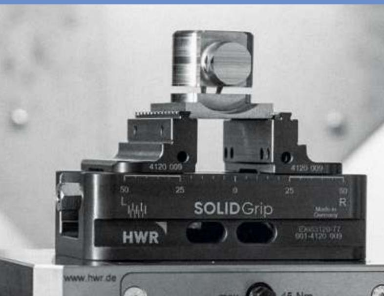
Prägespanntechnik ermöglicht maximale Haltekraft bei minimaler Einstanptiefe
