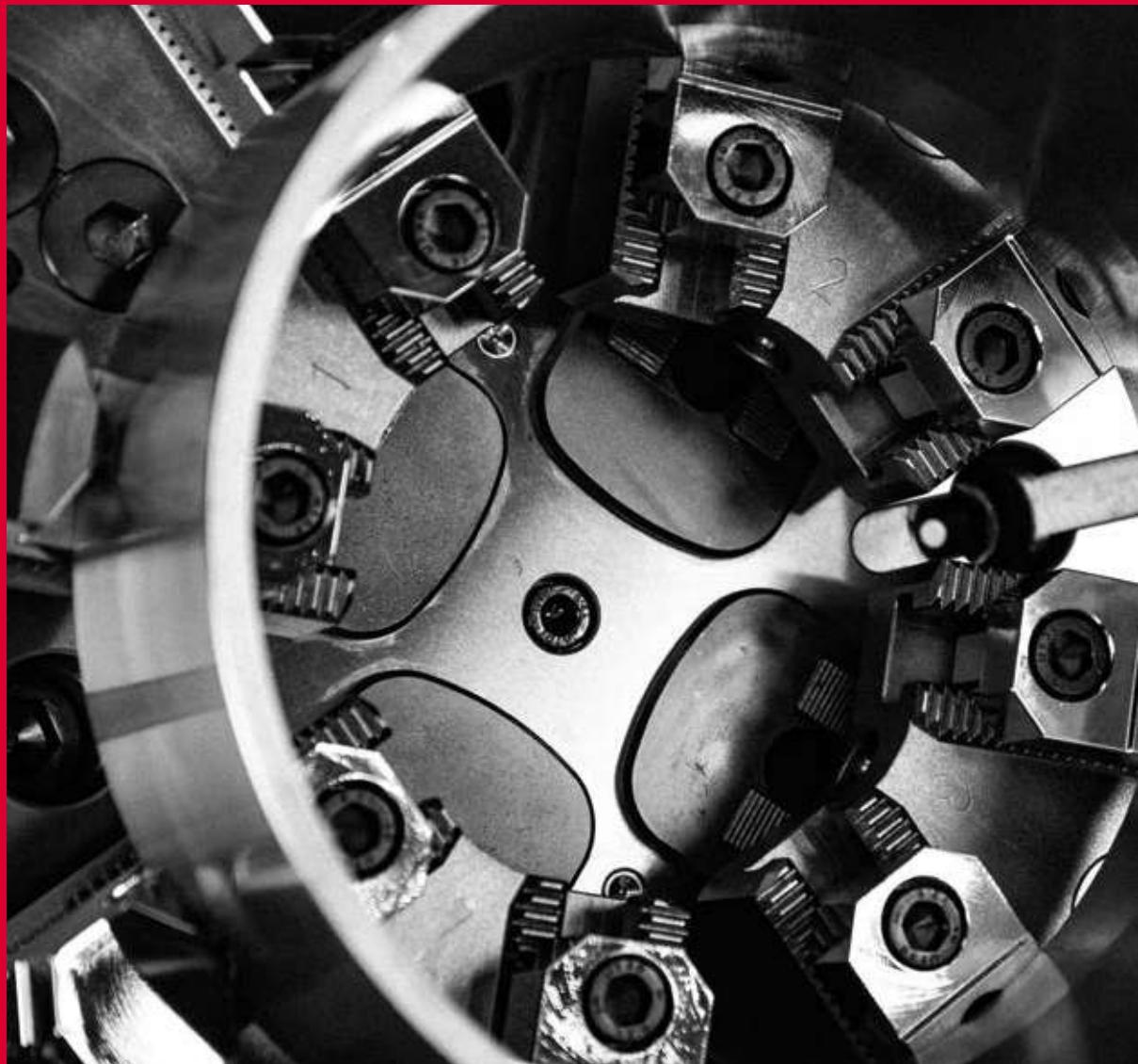
Ausgleichende 8-Punkt-Spannung durch **INOFlex®** und **INOZet®**
